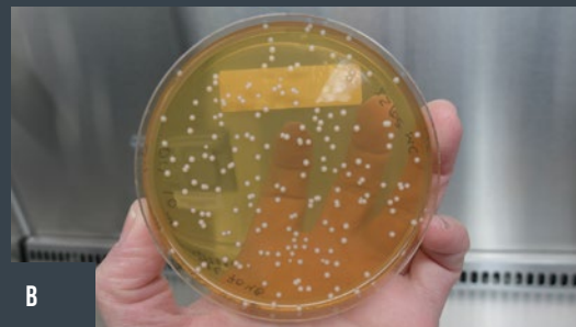
图1：比较亚甲基蓝染色法和平板法测定干酵母活性。(A) 亚甲基蓝测定结果误差大,活性低于30%,测得每克干酵母含8X10 8 活酵母。(B) 平板法得到结果和实际的较接近,测得每克干酵母含5X10 9 CFU。
